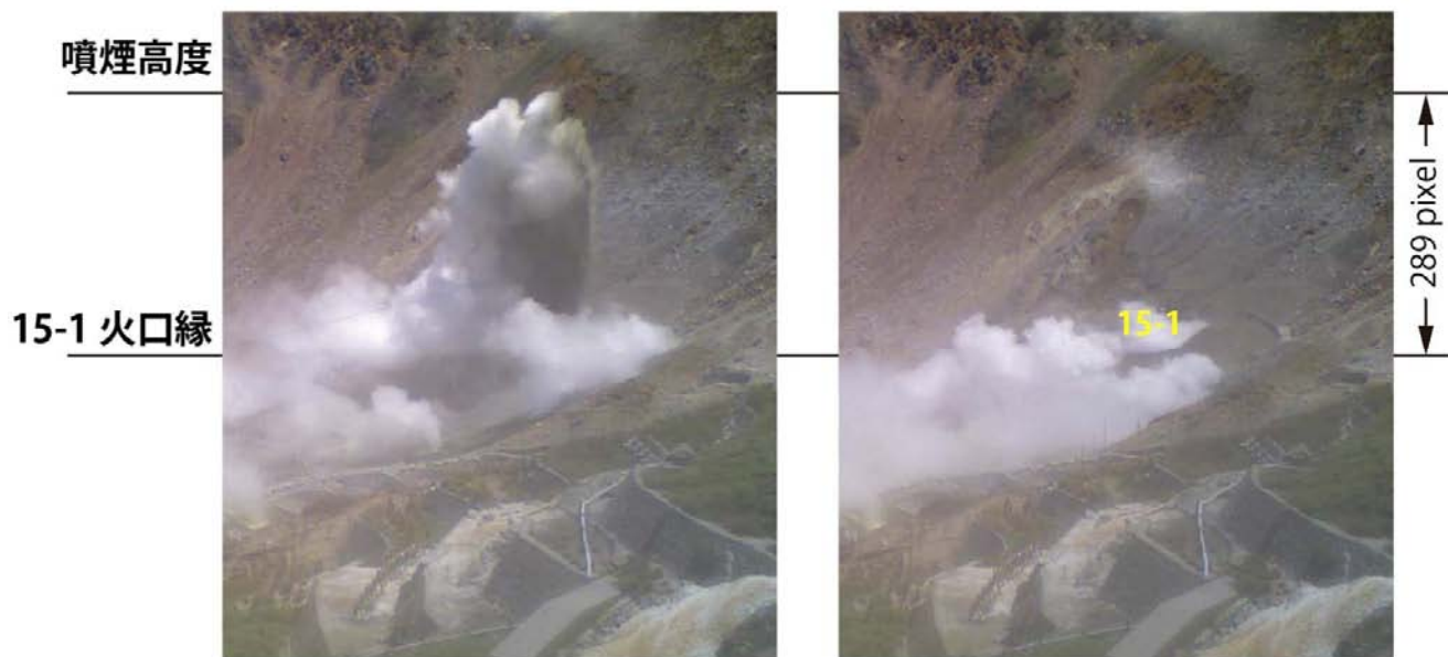
図 3 B 点に設置したタイムラプスカメラで撮影した、12:01 の噴出現象（左）および、15-1 火口縁が写っている直近の写真（右）。火口縁を基準とした噴煙高度は 289 ピクセルと測定された。
