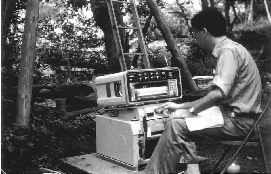
写真 2・1・32 電気検層調査 (1991年 7月)、井孔内の状況と温度分布測定
