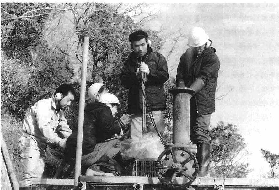
写真 2・1・21 火山性蒸気エネルギー測定 (湯の花沢)、温度140.2℃、熱量760kcal/sec (1989年10月)
