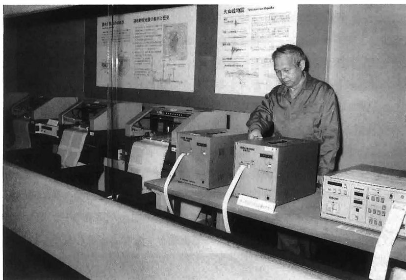
写真 2・2・9 1982 (昭和57) 年に煤書き方式から変更された記録計 (1984年 6 月)
