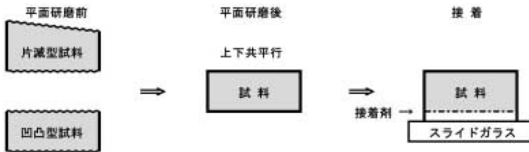
図2 基準面(接着面)研磨試料断面
