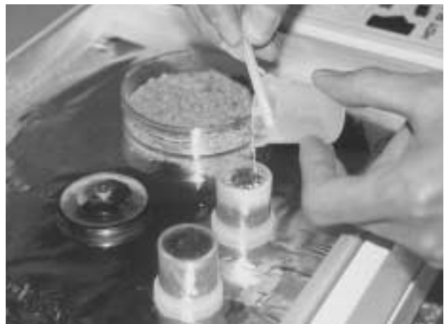
写真3 リングモールド内の試料に樹脂を流し込む
