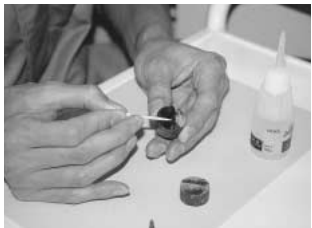
写真7 トリミングした試料切断面を再度、固化
