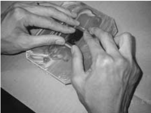
写真 11 手刷りによる仕上研磨
