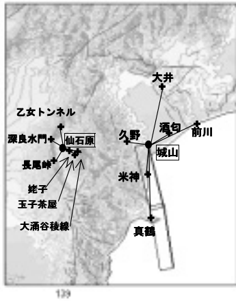
図 2 a) 光波測量網と県版想定断層モデル 囲み文字は、箱根観測網の基準点(仙石原)と小田原観測網の基準点(城山)を示す。
