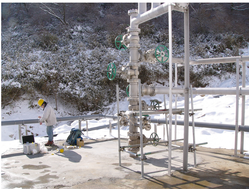
写真 16 蒸気井ガスの採取地点。配管バルブからガスを採取した。
