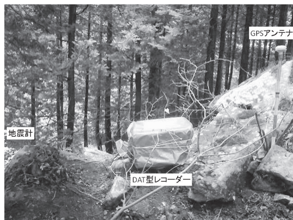
写真 1 臨時地震観測点設置概況（WK80J）。
