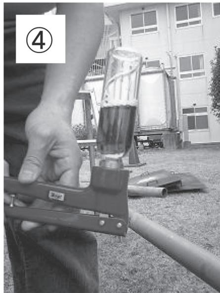
写真1 温泉付随ガス採取（水上置換法）の様子。
