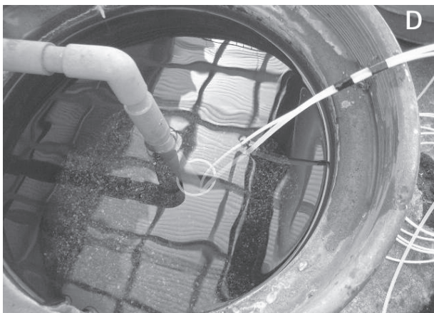
写真2 バルーンパッカー外観 (a)、及び測定風景 (b ~ e)
