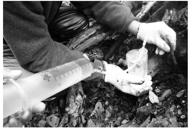
写真 1-2 噴気ガス採取方法 (2006年2月9日~2009年9月17日 (方法2))。ガラス製のロートと二口注射器の間に氷水で冷却した捕集ビンを取り付け、酸素・水素同位体比を測定するための凝縮水を採取する。そのほかは、方法1と同様である。
