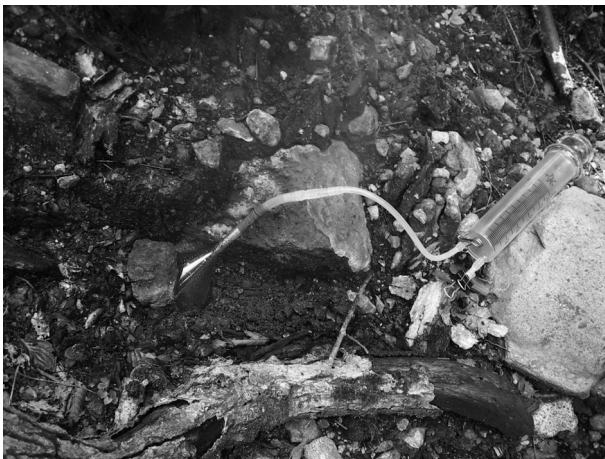
写真 1-1 噴気ガス採取方法 (2005年6月6日、7月6日 (方法1))。噴気孔にできるだけ隙間がないようにガラス製のロートをかぶせ、二口注射器で吸引して噴気ガスを採取する。二口注射器をほぼ気温にまで冷却した後、凝縮水を排除し、残ったガス中の硫化水素、二酸化硫黄、二酸化炭素を検知管で測定する。また、二口注射器から排除した凝縮水については、実験室に持ち帰った後、酸素・水素同位体比を測定する。
