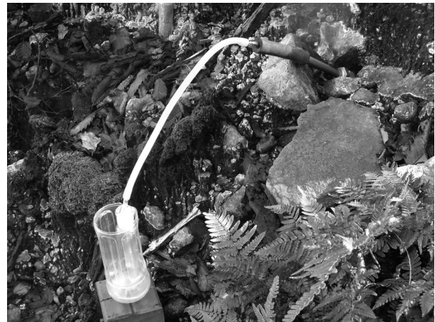
写真 1-3 噴気ガス採取方法 (2009年9月17日~2010年7月6日 (方法3))。チタン製のパイプを噴気孔に差し込んでガス採取をおこなう。そのほかは、方法2と同様である。
