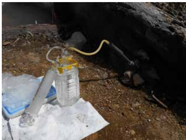
写真1 噴気ガス採取の様子。チタン製のパイプを噴気孔に差し込み、二口注射器で吸引して噴気ガスを採取する。その際、チタン製のパイプと二口注射器の間に氷水で冷却した捕集ビンを取り付け、噴気ガス中の水分を除去する（代田・板寺（2010）の方法3と同様）。水分除去後のガスについて、硫化水素、二酸化硫黄、二酸化炭素、酸素の濃度を検知管で測定する。
