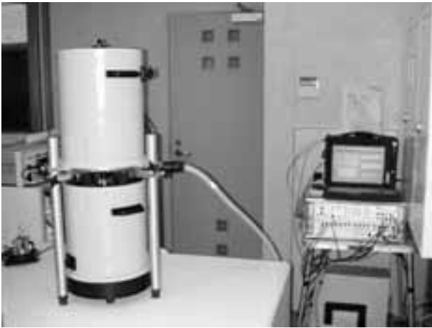
写真1 温泉地学研究所地震計室内のA-10システム。左にA-10本体、右に制御ユニットおよび制御用コンピュータがある。A-10は上部ユニットを支える脚を含めた直径が約50cm、上・下部ユニットを重ねた高さは約90cmである。なお、A-10本体は厚さ3250mmのコンクリートの観測台上に設置した。
