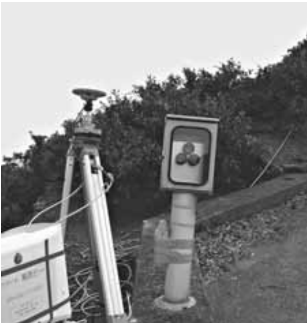
写真1 光波測量（米神反射点）と GPS 臨時観測。
