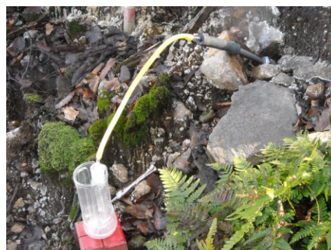
写真 1 噴気ガス採取の様子（左：ガラス製ロートを使用、右：チタン製パイプを使用）
