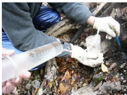
写真 1 噴気ガス採取の様子（左：ガラス製ロートを使用、右：チタン製パイプを使用）
