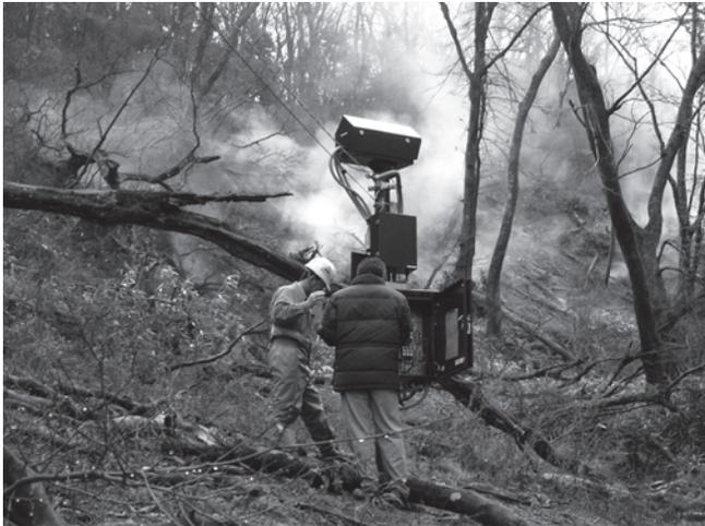
写真5 火山ガス・地温観測施設の設置（B点）
