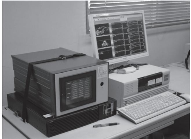
写真6 火山ガス・地温のデータ収録装置。
