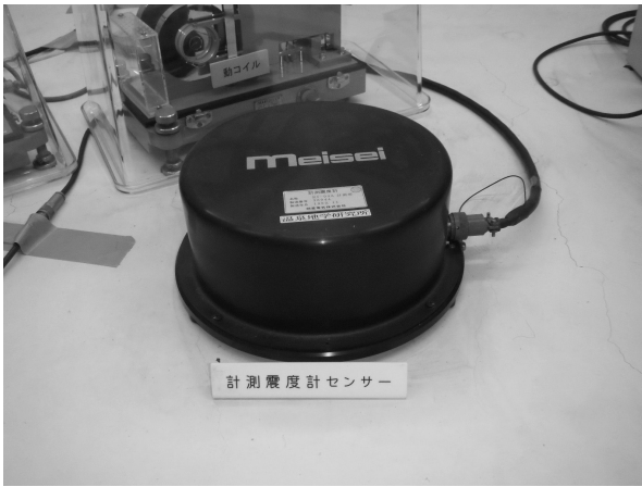
写真1 研究所に展示されている震度計。左側は地面の揺れを測定する「測定部」、右側は震度を自動計算する「計測部」
