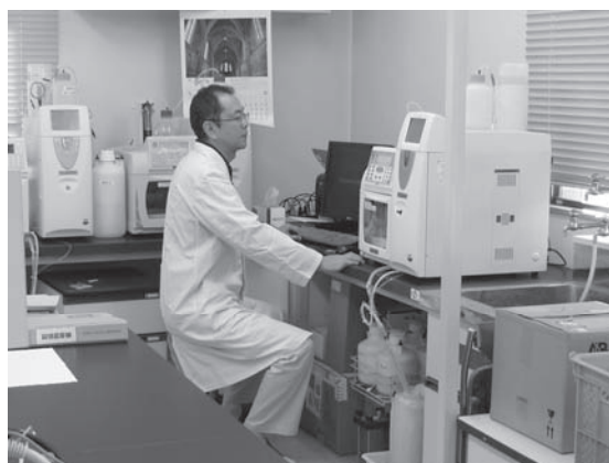
写真 3-1-9 イオンクロマトグラフによる温泉分析(2011 年 10 月)
