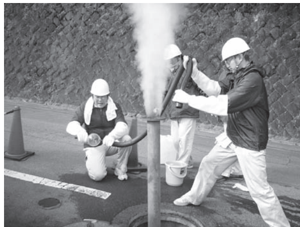
写真3-4-7 蒸気Iボギ-測定の実施(2011年1月)
