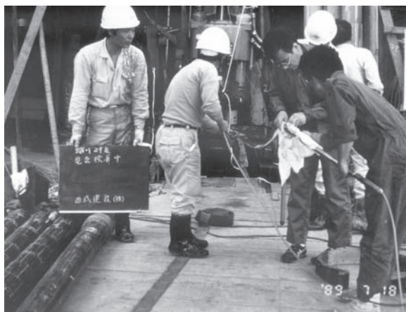
写真3-4-1 旧型電気検層、プロープの点検(1989年7月)
