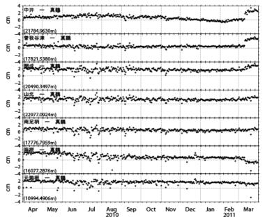
図6.5.1.-7 GPS測量結果 (平成22年度)
