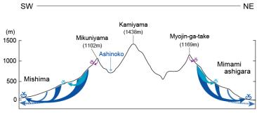
図6.3.10.-2 箱根外輪山斜面における地下水流動概念図
