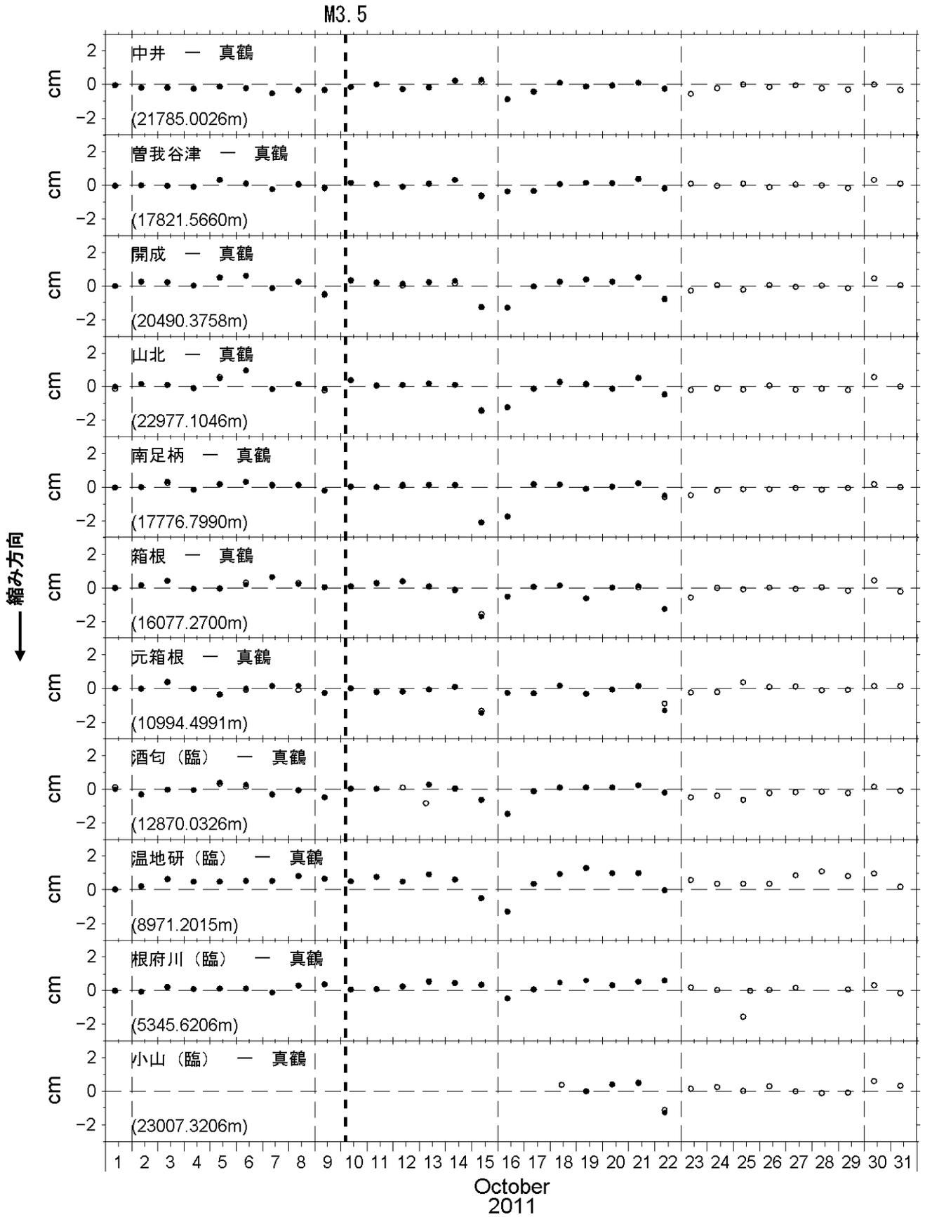
図 5 GPS測量観測結果 (2011年10月)
