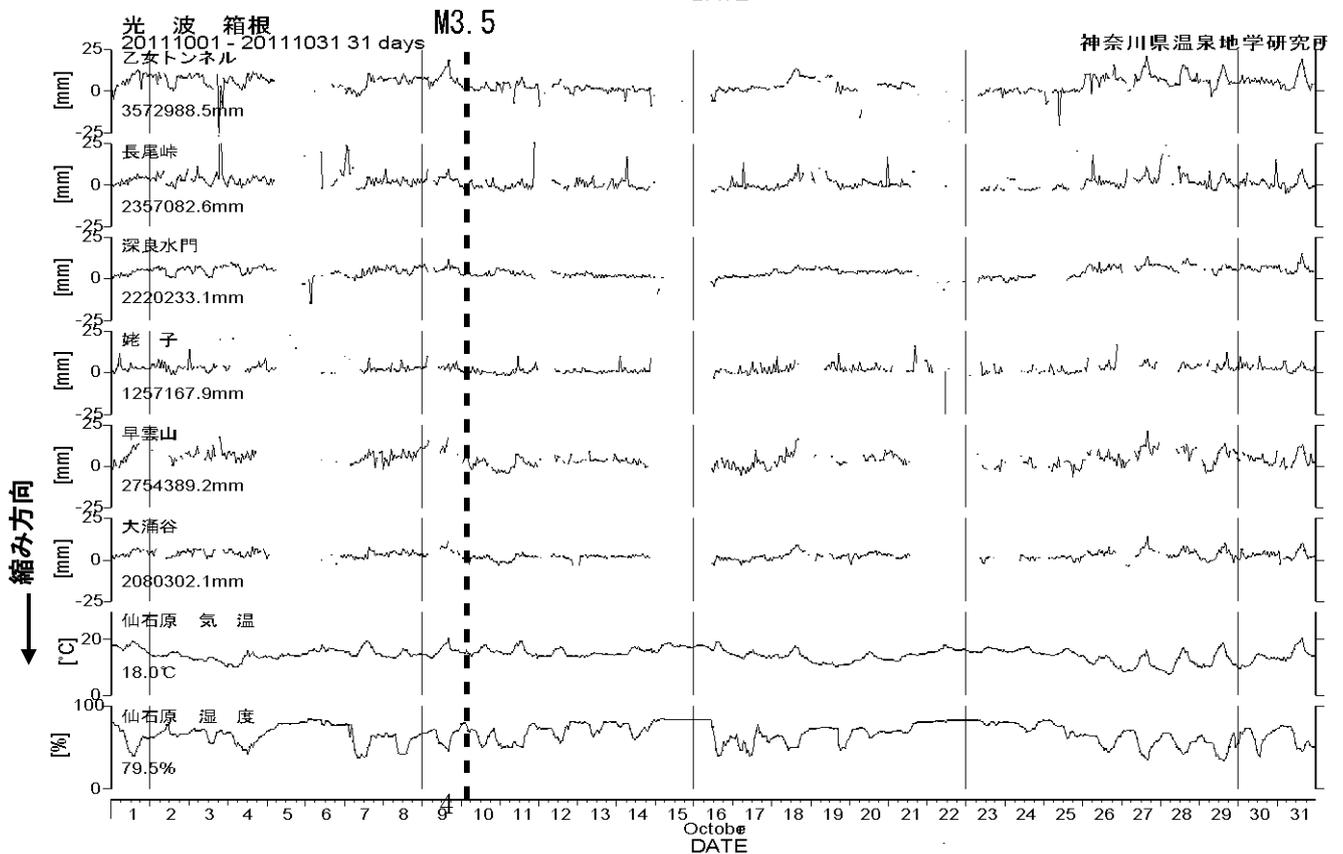
図4 光波測量観測結果 (2011年10月)
