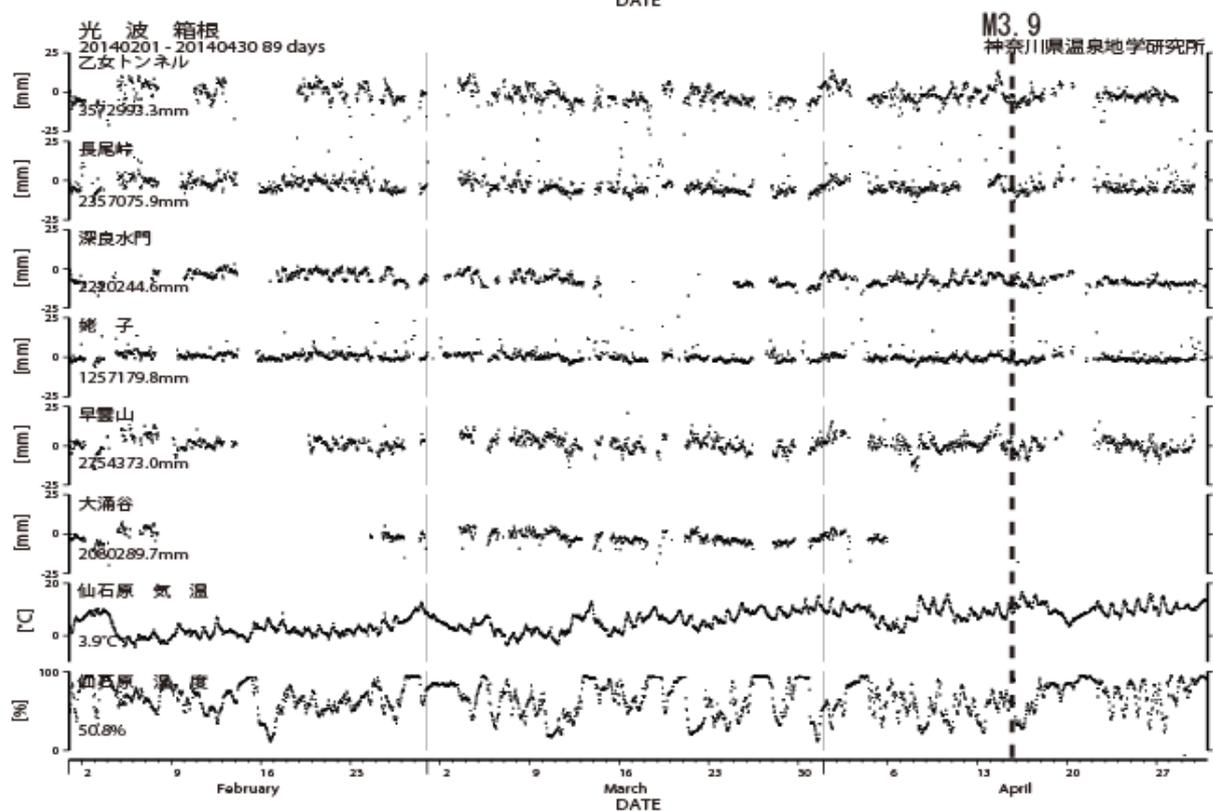
図5 光波測量観測結果 (2014年02月01日~2014年04月30日)
