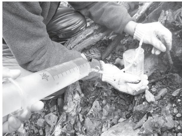
写真2 噴気ガス採取方法
