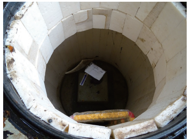
写真4 駒ヶ岳観測点の観測坑内に設置された広帯域地震計
