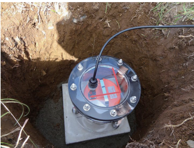
写真5 機動観測点の設置例。埋設前の地震計（山伏峠）。完成後。
