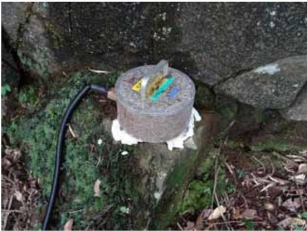
写真1 溶岩露頭の上に設置された地震計 ((L22E-3D))。場所はHKN29。
