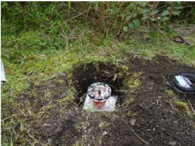
写真3 埋設用の穴に設置された地震計 (CDJ-S2C-2)。場所はHKN27。
