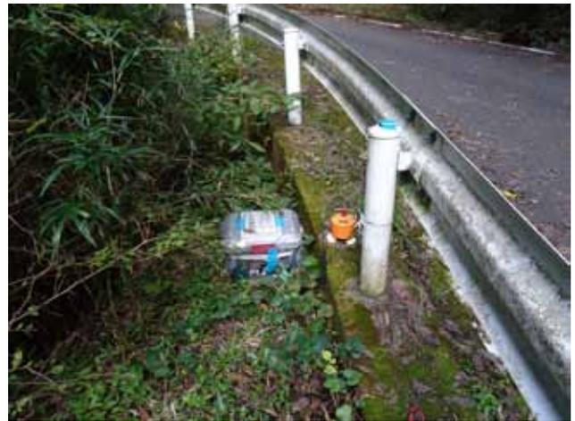
写真4 HKN35 に設置された地震計とデータ収録ロガー用ボックス。
