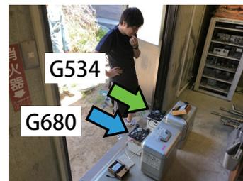
図3 (a) 大涌谷周辺の測地観測点の分布。背景には Google Earth Pro の衛星画像を用いており、黄色ピンは重力点、赤色丸印は水準点、[G] は重力点の名称、[L] は至近の水準点の名称を示している。(b) 旧スケート場入口付近の重力点 SkatePark。(c) 上湯バス停付近の重力点 Kamiyu。(d) 三叉路付近の重力点 T-junction。(e) 大涌谷の重力点 Owakudani。図 (b)-(e) において、黄色ピンは重力点の位置、緑色と青色の矢印はそれぞれラコスト重力計 G534 および G680 の設置方向を意味している。
