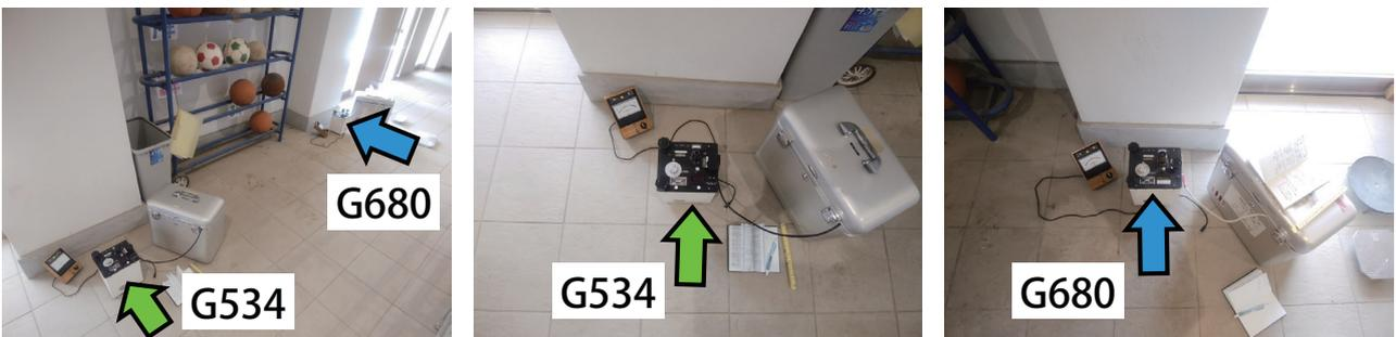
図2 (a) 箱根中学校の測地観測点の分布。背景には Google Earth Pro の衛星画像を用いており、黄色ピンは重力点 JHS-old および JHS-new、赤色丸印は電子基準点 93068 を示している。なお、図中では重力点および電子基準点を [G], [L] と略記している。(b) 箱根中学校屋外の重力点 JHS-old。(c) 箱根中学校玄関の重力点 JHS-new。図 (b)-(c) において、黄色ピンは重力点の位置、緑色と青色の矢印はそれぞれラコスト重力計 G534 および G680 の設置方向を意味している。
