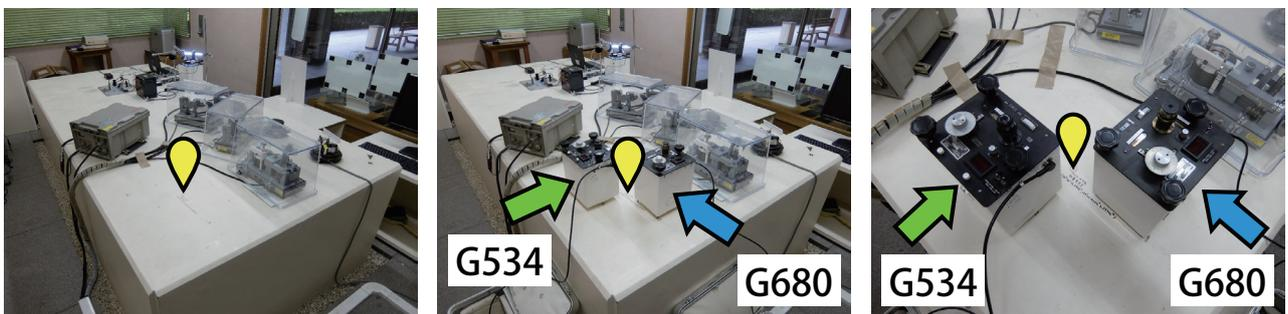
図 1 (a) 箱根火山周辺の測地・気象観測点の分布。背景には Google Earth Pro の衛星画像を用いており、黄色ピンは重力点、赤色丸印は水準点 (村瀬ほか, 2018)、白線矩形は 2015 年箱根火山活動時の貫入ダイク (Honda *et al.*, 2018)、水色四角は箱根アメダス観測点、緑色四角は小田原アメダス観測点を示している。なお、貫入ダイクを示す矩形のうち、最も地表に近い 1 辺を白色太線で示している。(b) 温泉地学研究所の重力点 Onken の周囲の様子。黄色ピンは重力点の位置、緑色と青色の矢印はそれぞれラコスト重力計 G534 および G680 の設置方向を意味している。
