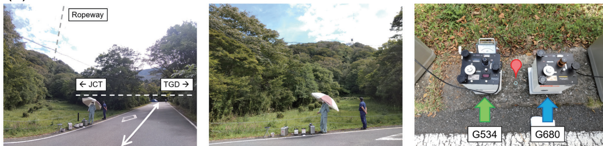
図3 重力点の写真。赤色ピンは重力点の位置、緑色矢印は G534 重力計の配置、水色矢印は G680 重力計の配置を示している。(a) は三叉路 JCT、(b) は姥子 UBK の様子で、これ以外の重力点の写真は先行論文（風間ほか，2019）に掲載されている。
