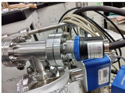
写真 イオントラップ型質量計 (このフィラメントの納品が遅延している)
