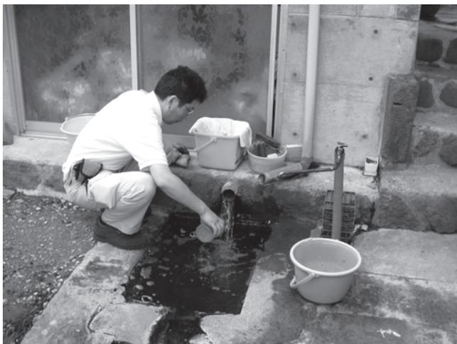
写真 13 現地で、温度・pH・電気伝導度・湯量を測定し、採水を行いました。採取した温泉水は研究所で鉱泉分析法指針に準じて分析しました。
