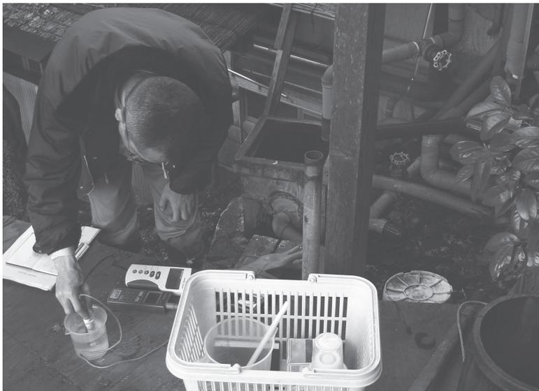
写真 6 宮ノ下温泉での温泉分析の様子。温泉水の pH と電気伝導率を測定しています。
