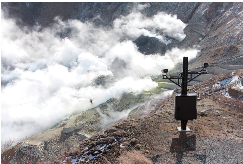
写真6 大涌谷に設置した噴気監視カメラ（2016年2月19日撮影）。
