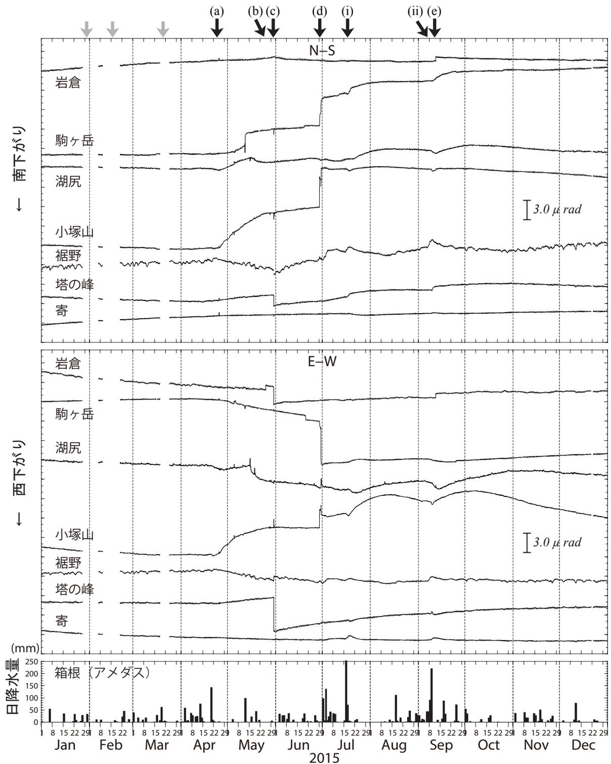
図2 2015年の傾斜観測結果。図は上から南北成分、東西成分、箱根(気象庁アメダス観測点)における日降水量を示す。(a)～(e)は地震に伴う傾斜変動(本文参照)、(i)～(ii)は降雨による影響(本文参照)、灰色矢印は傾斜計自体の機械的な変化や装置の一時的な不具合を表す。
