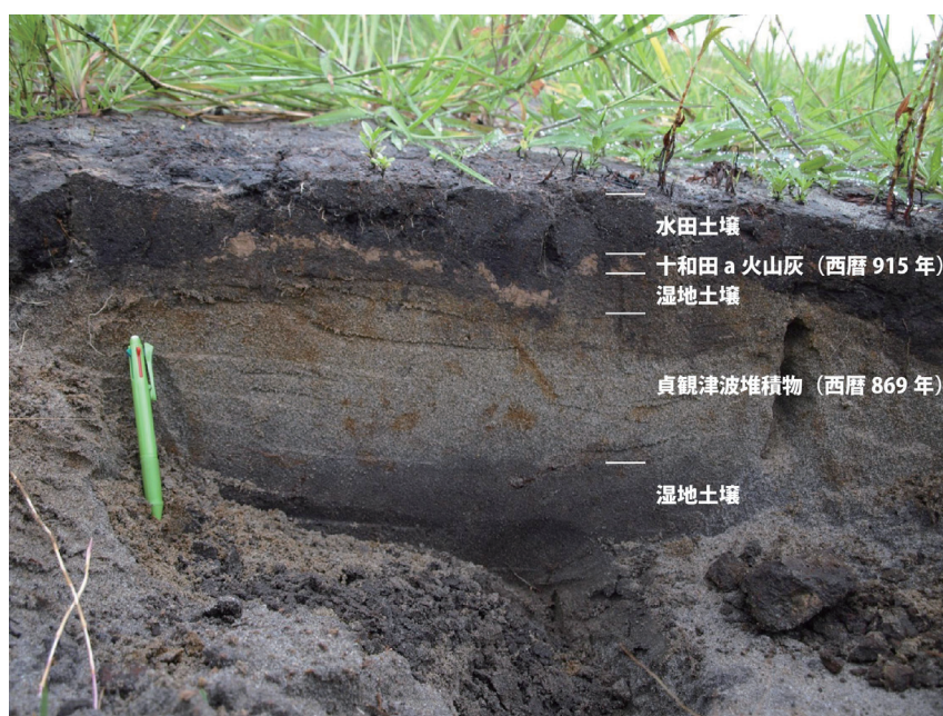
写真2 海岸低地に溜まった津波堆積物の例 (仙台市荒浜地区；2011年8月21日撮影)。
