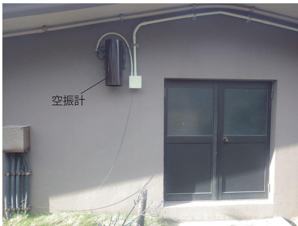
写真1 大涌谷地蔵尊観測点に設置された空振計。
