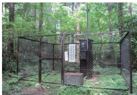
図5 ボアホール型地震・傾斜観測点
