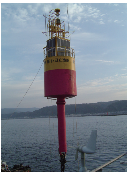
図5a 2004年4月年室戸岬沖に設置されたGPS津波計。
