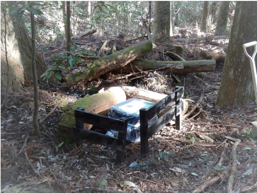
写真 4 野生動物への対策を施して再設置した観測点 木製柵や丸太で周囲を囲み、周囲に忌避剤、唐辛子を散布しました。
