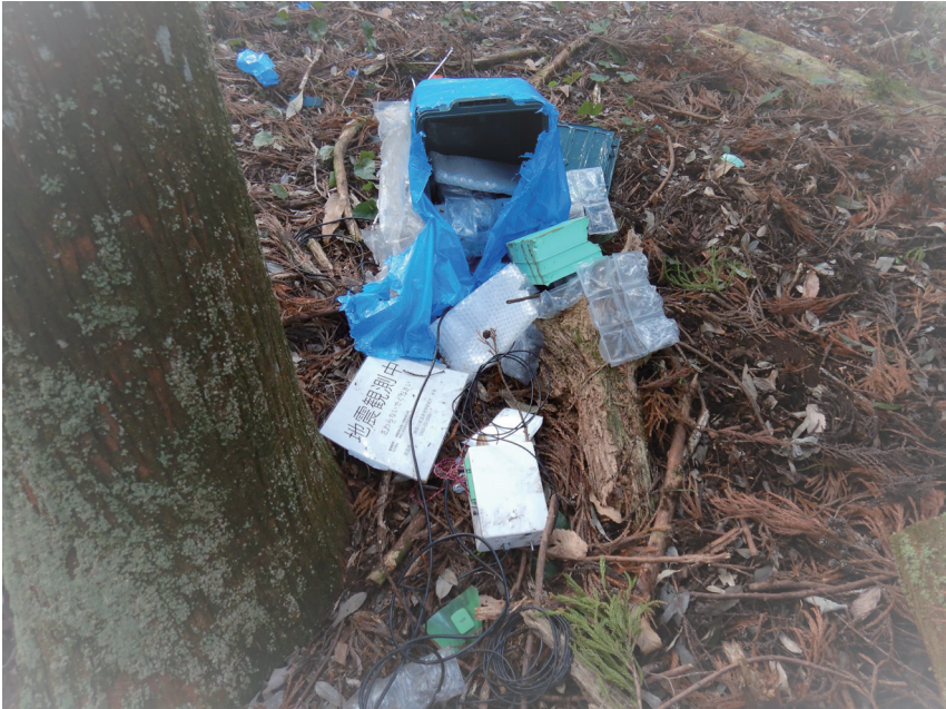
写真 3 野生動物に襲われた観測点 この観測点では、箱が破壊され収納した機器が周囲に散乱していました。
