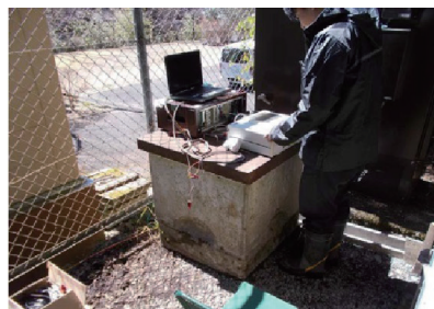
写真 7 地震・傾斜計設置後の最終動作試験の様子。
