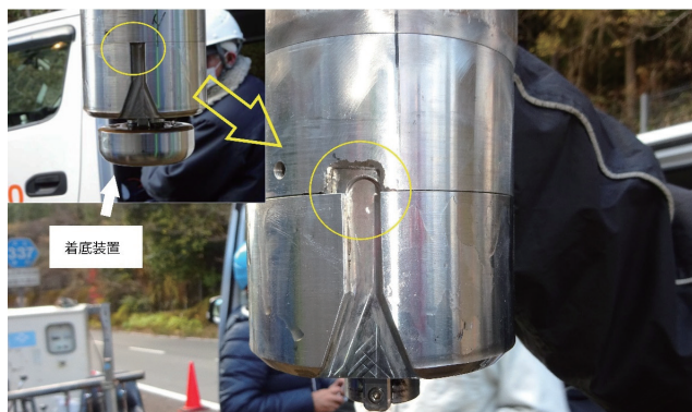
写真12 地震・傾斜計の先端。左上の写真で最下部についているドーム状の部品が着底装置。キー溝の長さが足りなかったため、現地で溝を削る作業を行いました。
