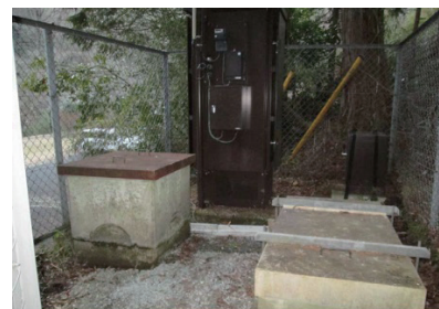
写真2 小塚山観測点の施設内。正面奥の茶色の箱がテレメータ装置などを収納する筐体。左のコンクリート製の箱が、地震・傾斜計が埋設された観測井戸。手前右にあるのが、強震計が収納されている地震計台。
