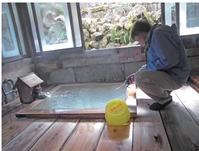
写真 17 硫黄泉を利用した浴槽の硫化水素調査風景。管内の保健所が温泉から出てきたガス濃度を測定して安全を確認しています。
