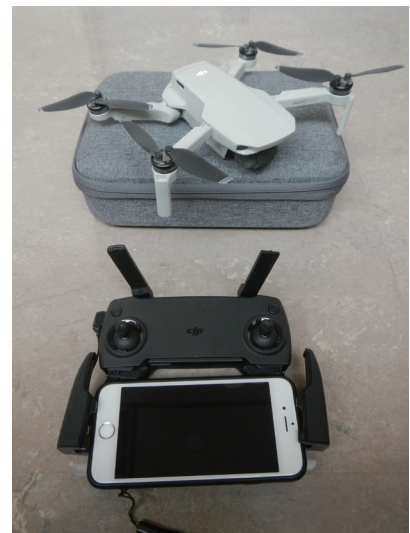
図 3 mavic mini 本体及び送信機（プロポ）。本体の下にあるケースは本体と送信機を収納できるキャリングケースとなっている。送信機に取り付けてあるスマートフォンは iPhone 6s。
