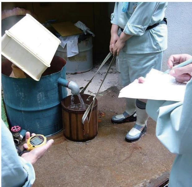
図 2 揚湯試験。桶に温泉水がたまる時間をストップウォッチで計測し、1 分当たりの流量を求める。
