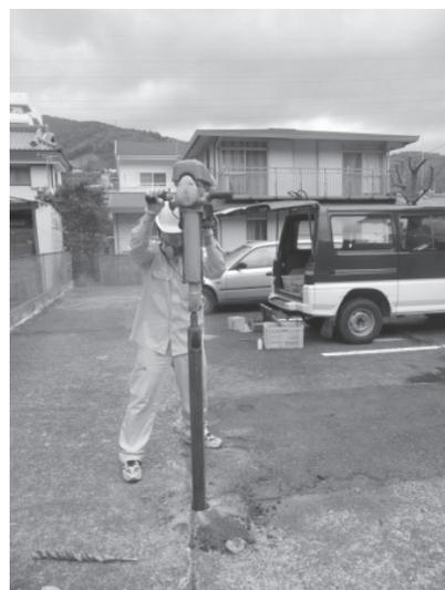
写真1-10 地下水汚染調査のSCSCボーリング(2010年8月)
