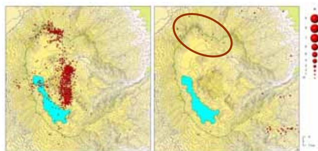
図6.3.5.-1 2006年震源分布 (左; 深さ-1~9km、右; 深さ15~20km) 右図の楕円内が深部低周波地震である。
