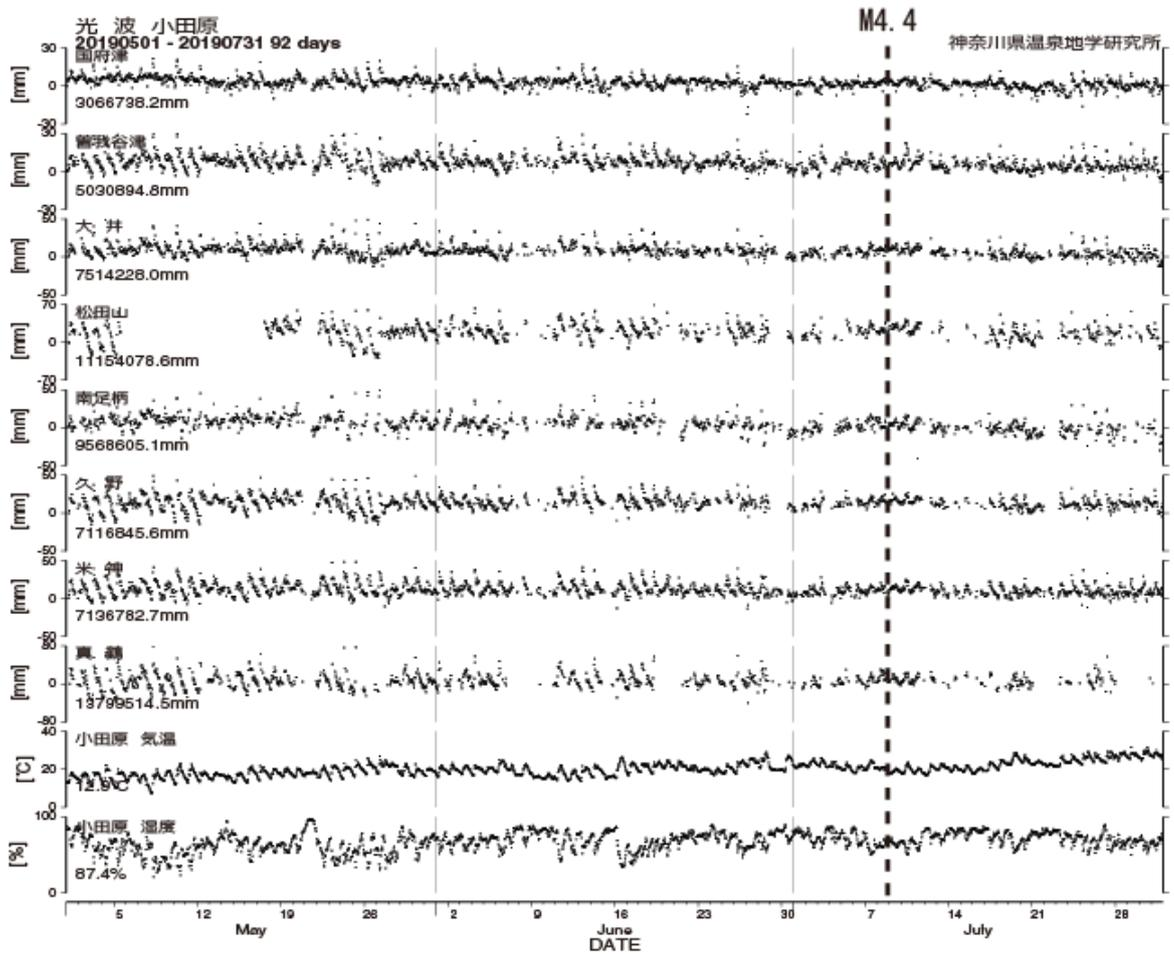
図5 光波測量（小田原観測網）観測結果（2019年05月01日～2019年07月31日）
