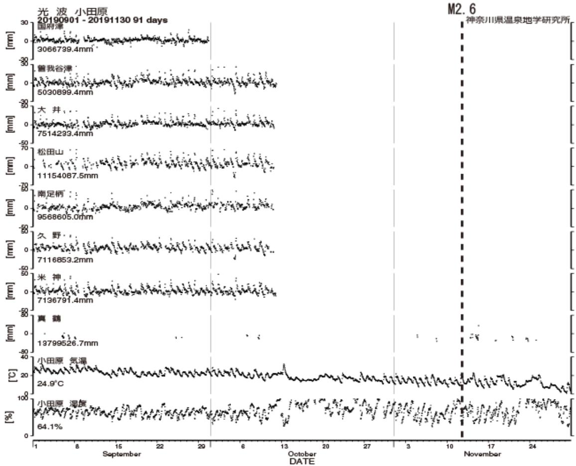
図5 光波測量（小田原観測網）観測結果（2019年09月01日～2019年11月30日）
