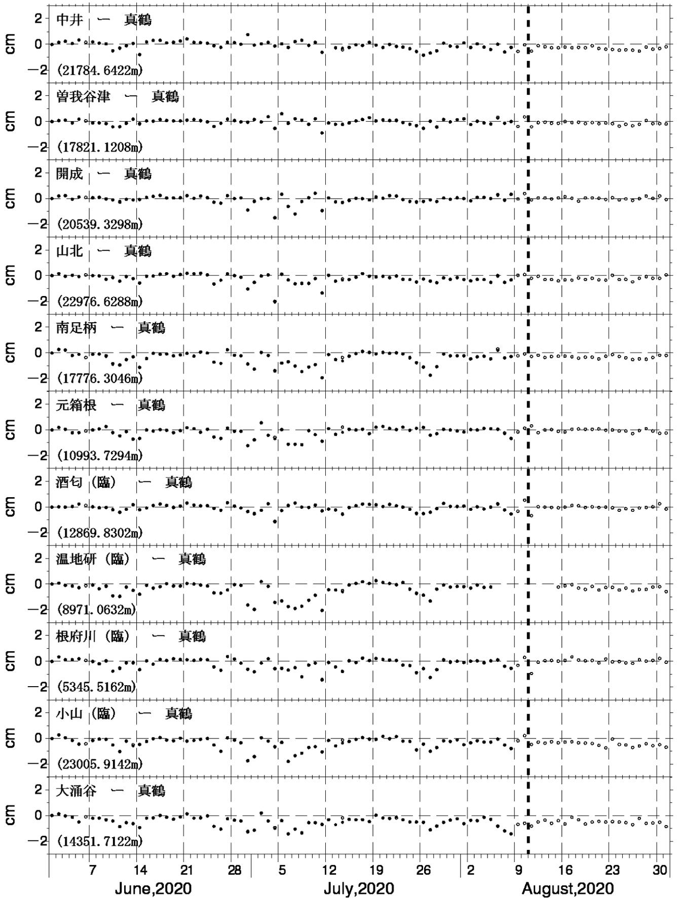
図4 GNSS測量観測結果 (2020年06月01日~2020年08月31日)
