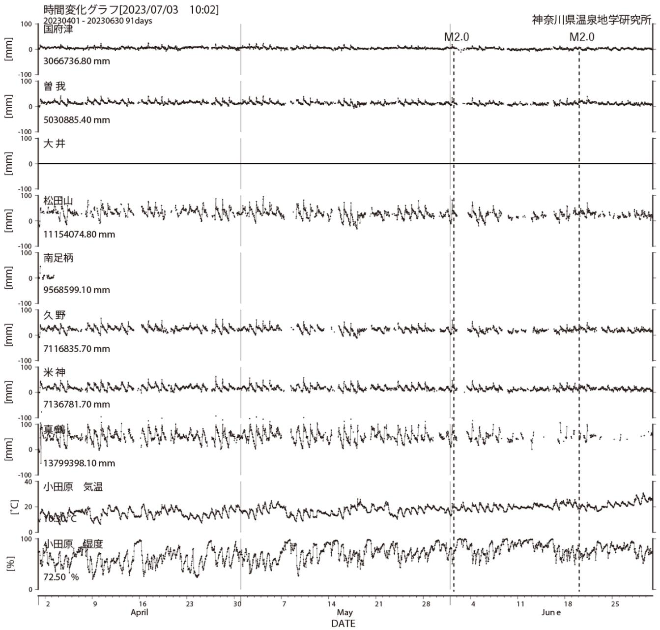
図5 光波測量(小田原観測網)観測結果(2023年04月01日~2023年06月30日)
