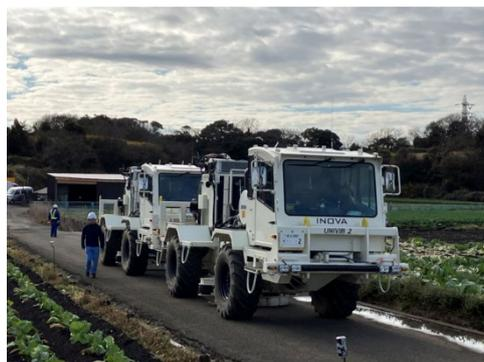
図 3 人工地震探査の様子
